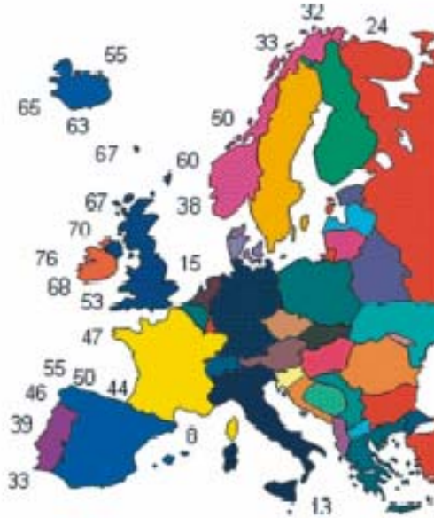
Figura 5.20. Potencial energètic de les onades (kW/m longitudinal de cresta) a Europa Font: "Wave energy utilization in Europe". Comissió Europea
